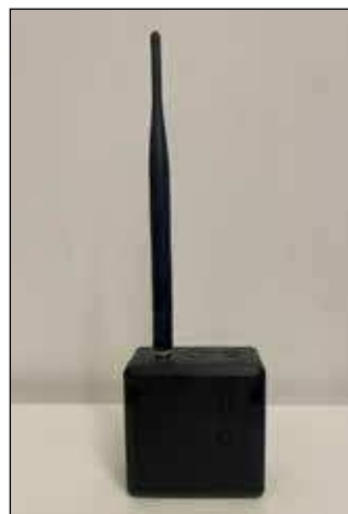
Figura 7 - clinometro di produzione Axcent
