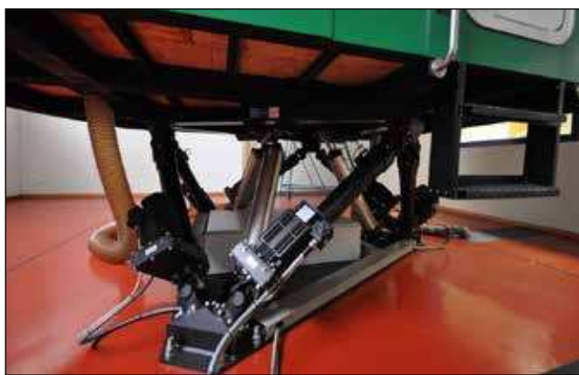
Fig. 3 - Attuatori della postazione di addestramento dinamica del SIDAC
