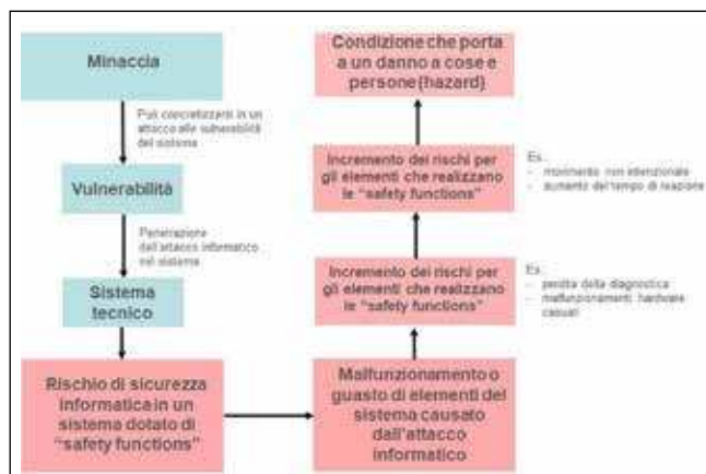
Figura 4: Catena di causa ed effetto tra attacco informatico e rischio per la sicurezza funzionale
