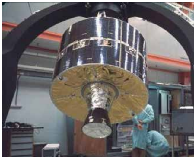
Figura n. 3. - Sirio: preparazione per simulazione solare, Vista motore d'Apogeo
